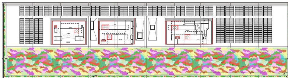
Figura 6 - Edificio Terminal, Copertura: Impianti tecnologici
