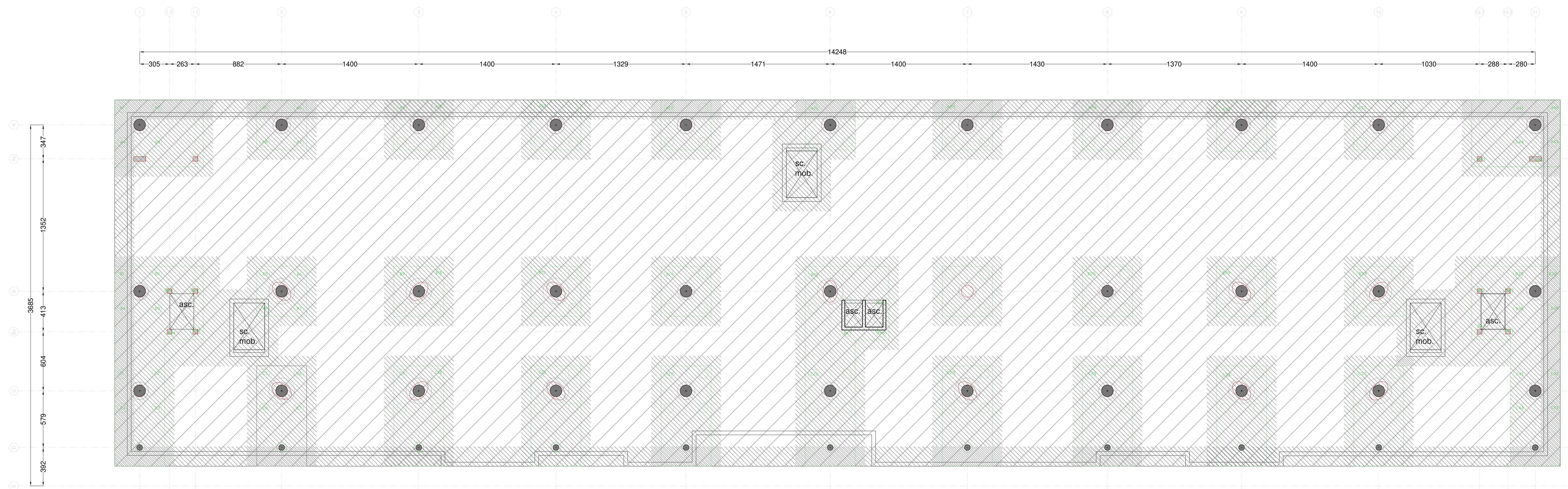
PIANTA ARMATURE PLATEA scala 1:200 ARMATURA BASE MAGLIA DI BASE SUPERIORE Ø 28 PASSO 20X20 cm ARMATURA SUPPLEMENTARE
