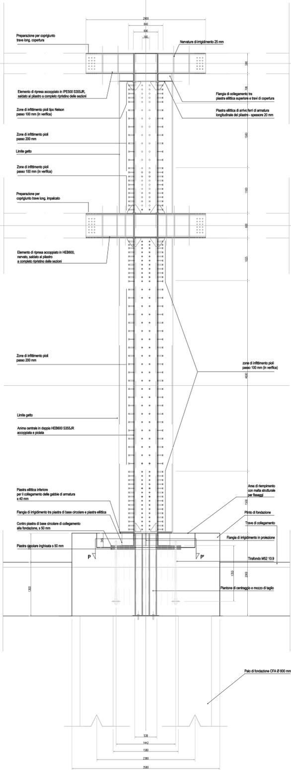
SEZIONE VERTICALE A-A' con vista delle armature
