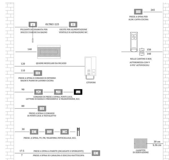
NOTA: Tutte le apparecchiature devono essere installate ad una distanza minima di 10 cm da qualsiasi serramento finito (porta o finestra) e dai vigili delle pareti dei locali.
