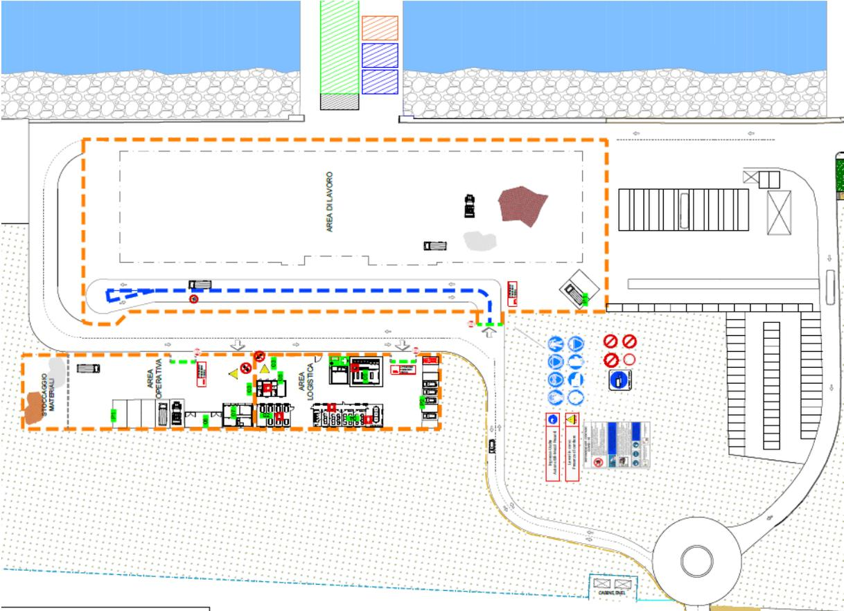
Figura 5.1: RAV PE-H4-Planimetria e Viabilità di Cantiere Fase 1
