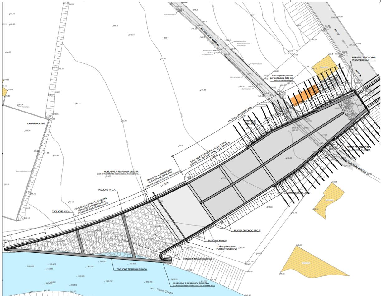
Figura 10. Planimetria manufatto di scarico e restituzione nel PE (elaborato: PE-SBO-OSD-GE-002-PL-A)
