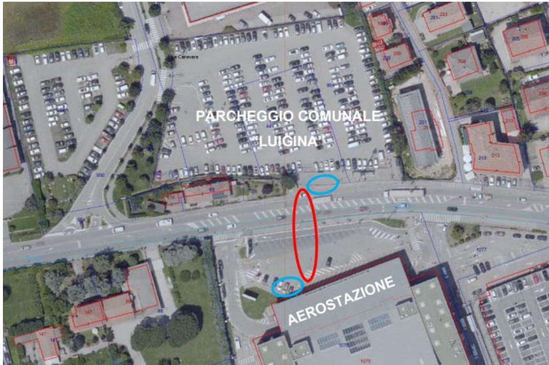
Figura 3-4 Ortofoto dello stato di fatto. In rosso l'area del sovrappasso, in blu le aree occupate dalle pile e dai sistemi di risalita del sovrappasso.
