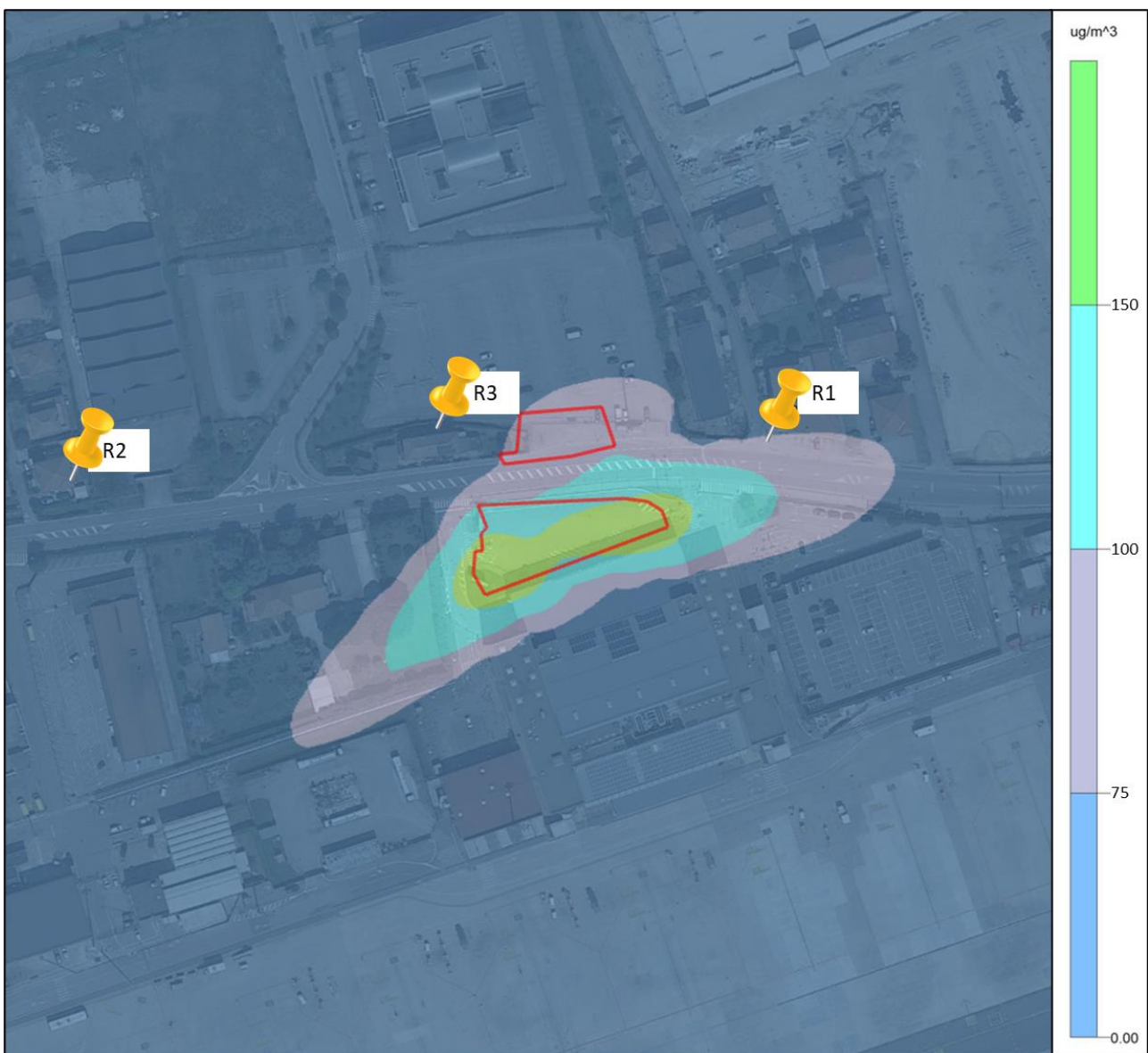
Figura 10-17 Concentrazioni di \text{NO}_2 , massimo valore di media oraria (in rosso i cantieri)
