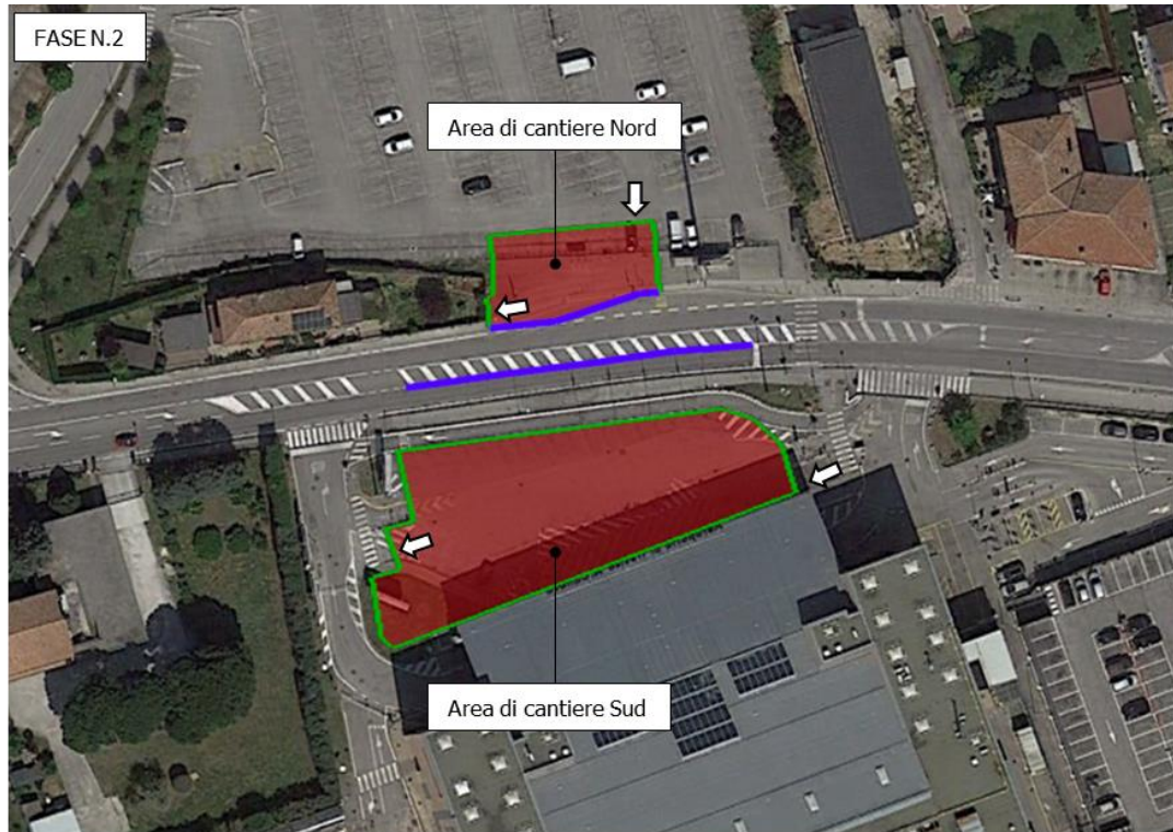
■ Area di cantiere — New Jersey — Recinzione con pannelli ciechi (H = 2 metri) ⇨ Ingresso e uscita cantieri
