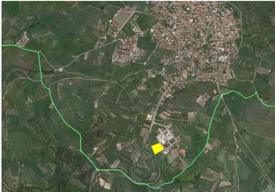
Figura 10.1: Individuazione area cantiere base di Orroli (poligono giallo) e tracciato del cavo interrato 380 kV di utenza (verde)
