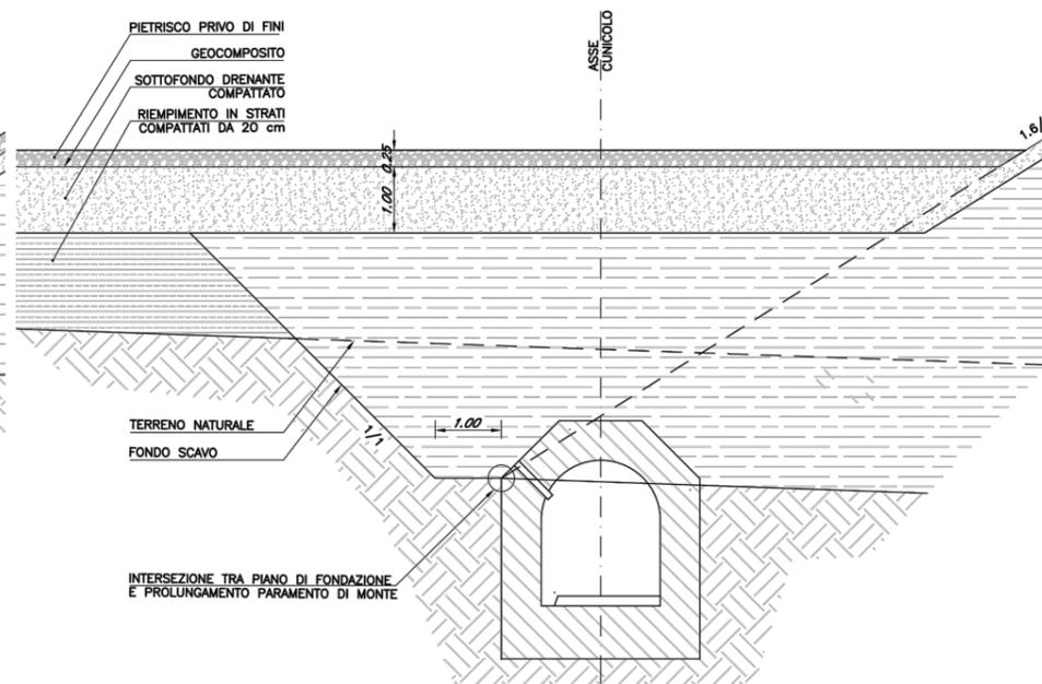
DETTAGLIO DELLA TUBAZIONE DI DRENAGGIO
