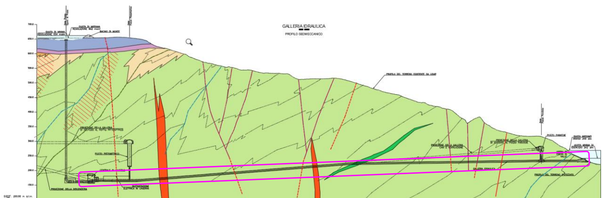
Figura 5.1 – Profilo in asse galleria (riquadro fucsia)
