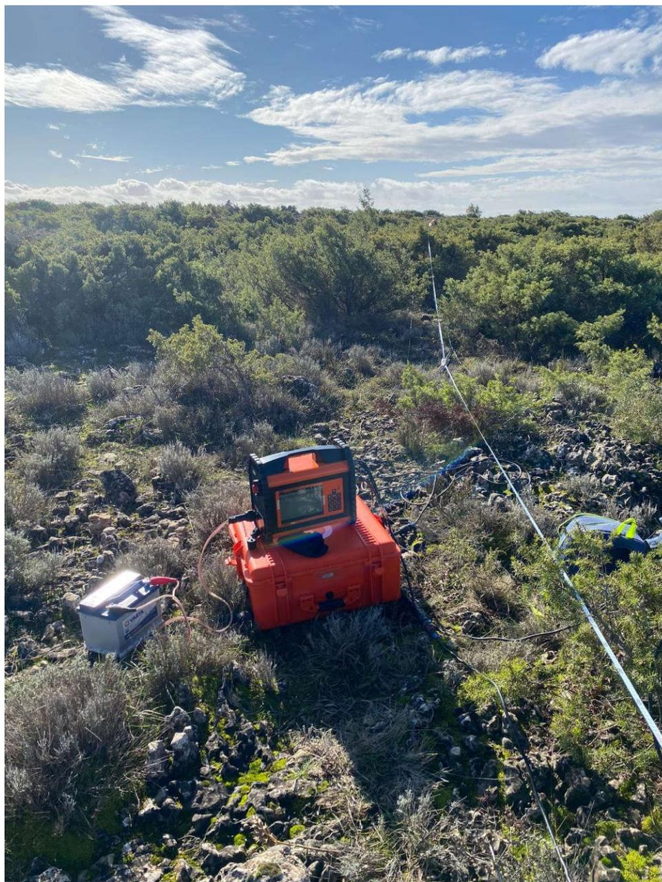
Foto 4 - Posizionamento del georesistivometro nel punto centrale di ERT-1 durante le fasi di acquisizione dati.
