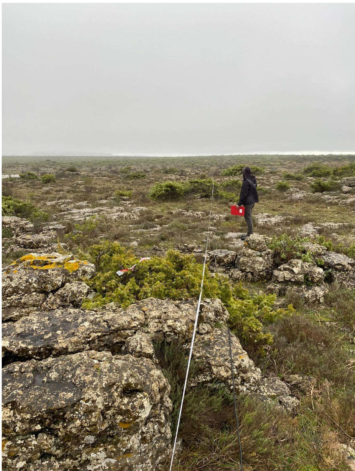
**Foto 5 - Rilevamento della topografia nel tratto centrale di ERT-2. In primo piano affioramento di dolomie.**
