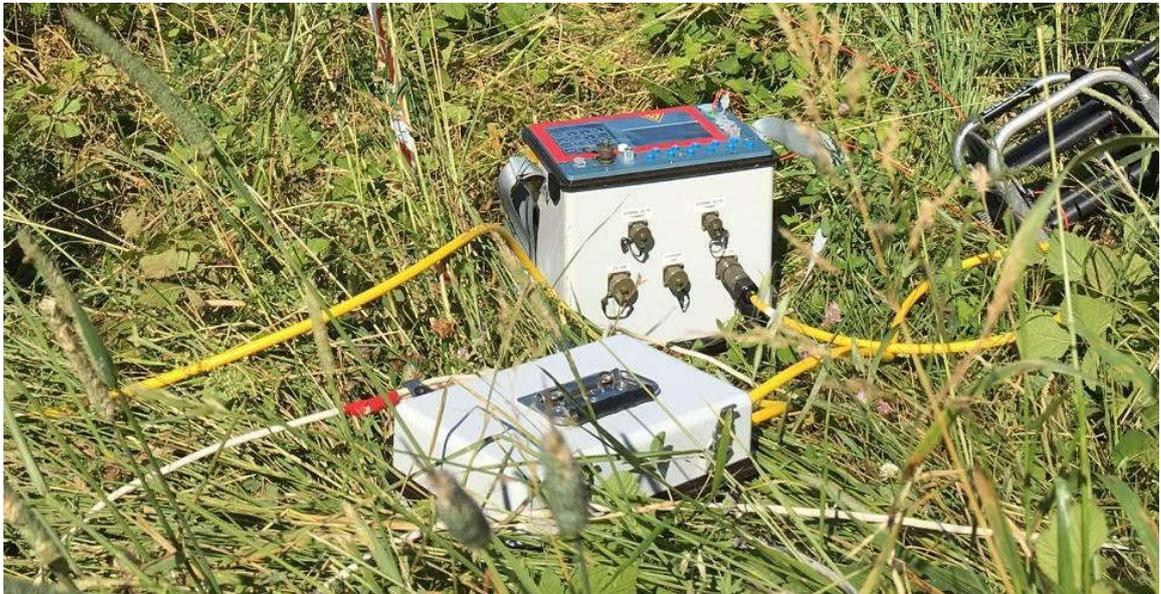
Figura 11 - Strumentazione di misura IRIS – Syscal PRO Switch 48
