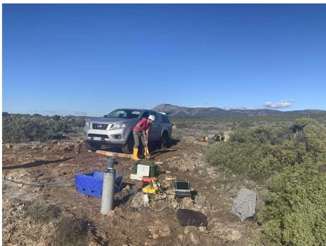
Figura 14 - Sistema di generazione delle onde SH
