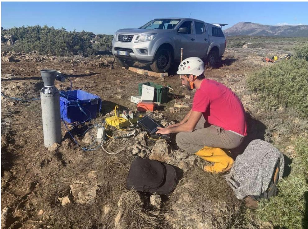
Figura 13 – Down-hole DH-S1 fase di acquisizione
