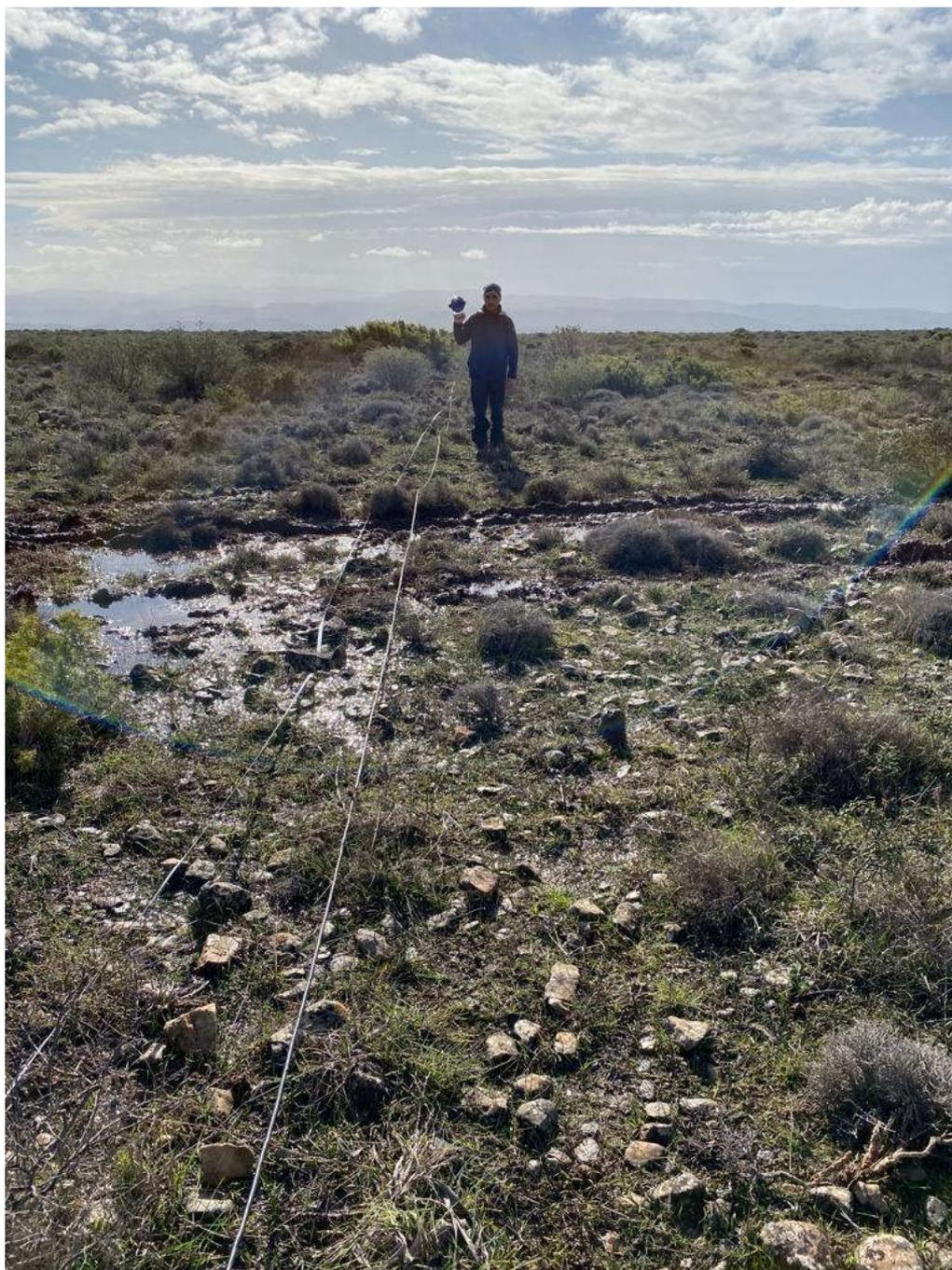
**Foto 3 - Rilevamento del profilo topografico nel tratto iniziale della linea ERT-1 mediante clinometro.**
