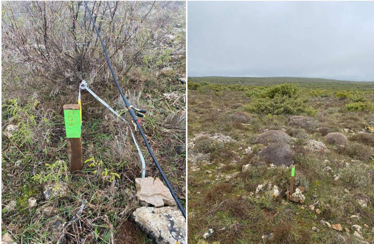
**Foto 1 - Localizzazione degli estremi delle linee ERT sul campo mediante picchetti in legno.**
