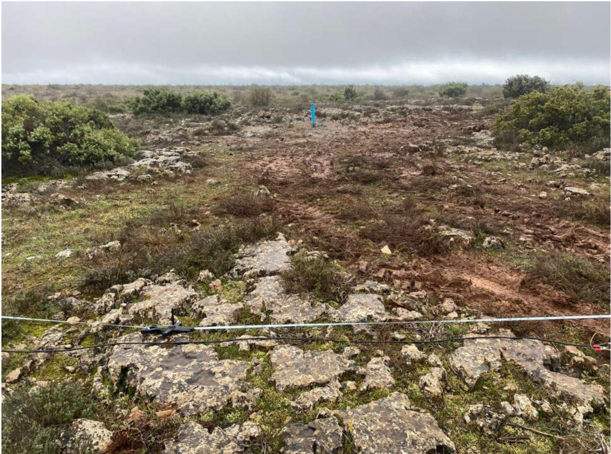
**Foto 7 - Localizzazione del sondaggio NA-1 (tubo blu) rispetto alla linea di acquisizione dati ERT-2 (100 m circa dall'inizio del profilo). In primo piano affioramento di dolomie.**
