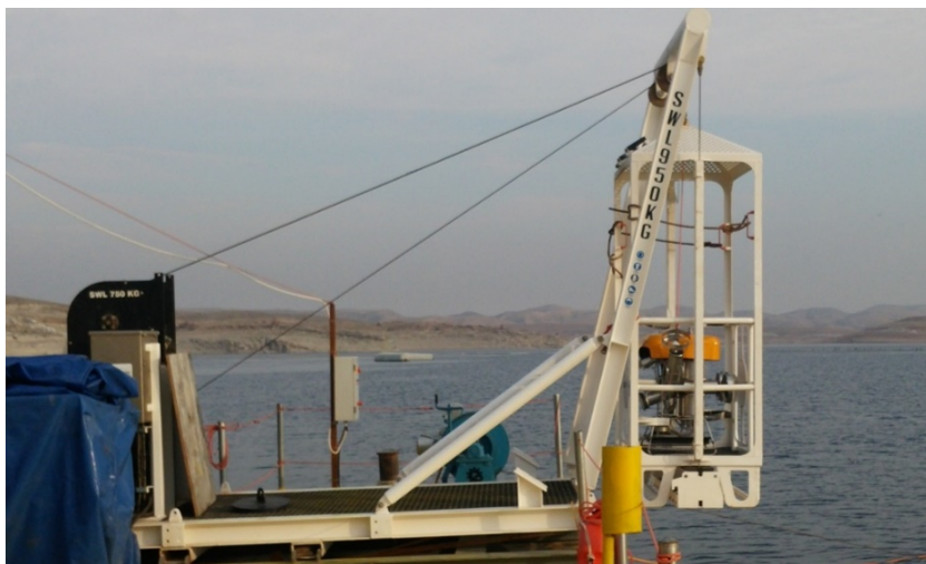
Sistema LARS per discesa e risalita sommozzatori
