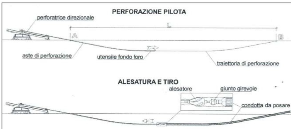
Posa in TOC su terreno
