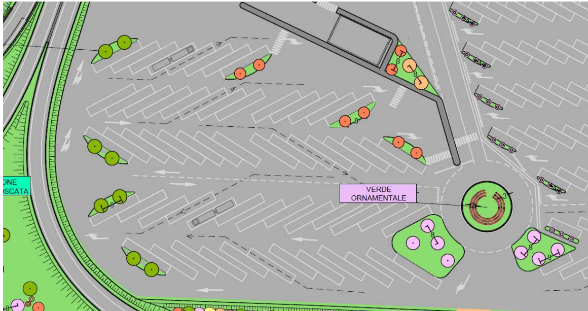
Figura 6 – Filari arborei di ombreggiamento (zona sud-ovest Autoporto)
