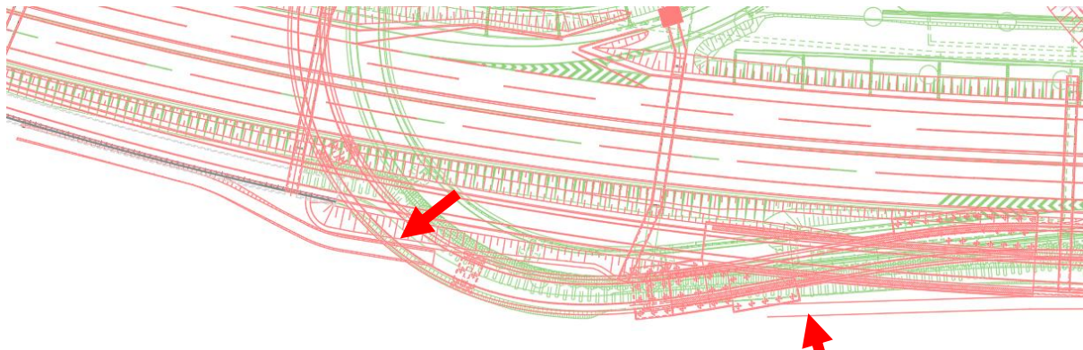
Figura 23 - Ambito Svincolo Ovest. Sovrapposizione tra PE approvato (in verde) e Variante (in rosso). La pista di servizio a sud dell'autostrada subisce una modifica del tracciato sottopassando il sovrappasso e avvicinandosi al rilevato dell'A32 (freccia rossa)
