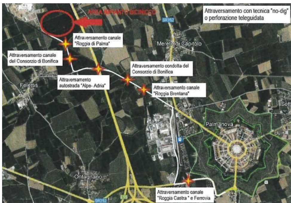
Figura 3 - Interferenze lungo il percorso dei cavidotti
