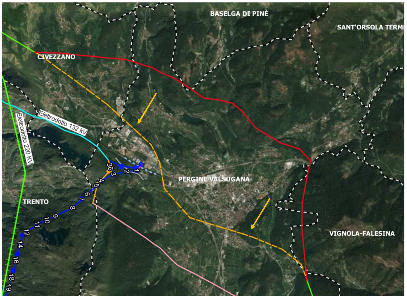
Figura 2 – Interventi sulla rete 220 kV – in rosso il tratto di variante, in arancione (indicato con freccia arancione) il corrispondente tratto oggetto di dismissione
