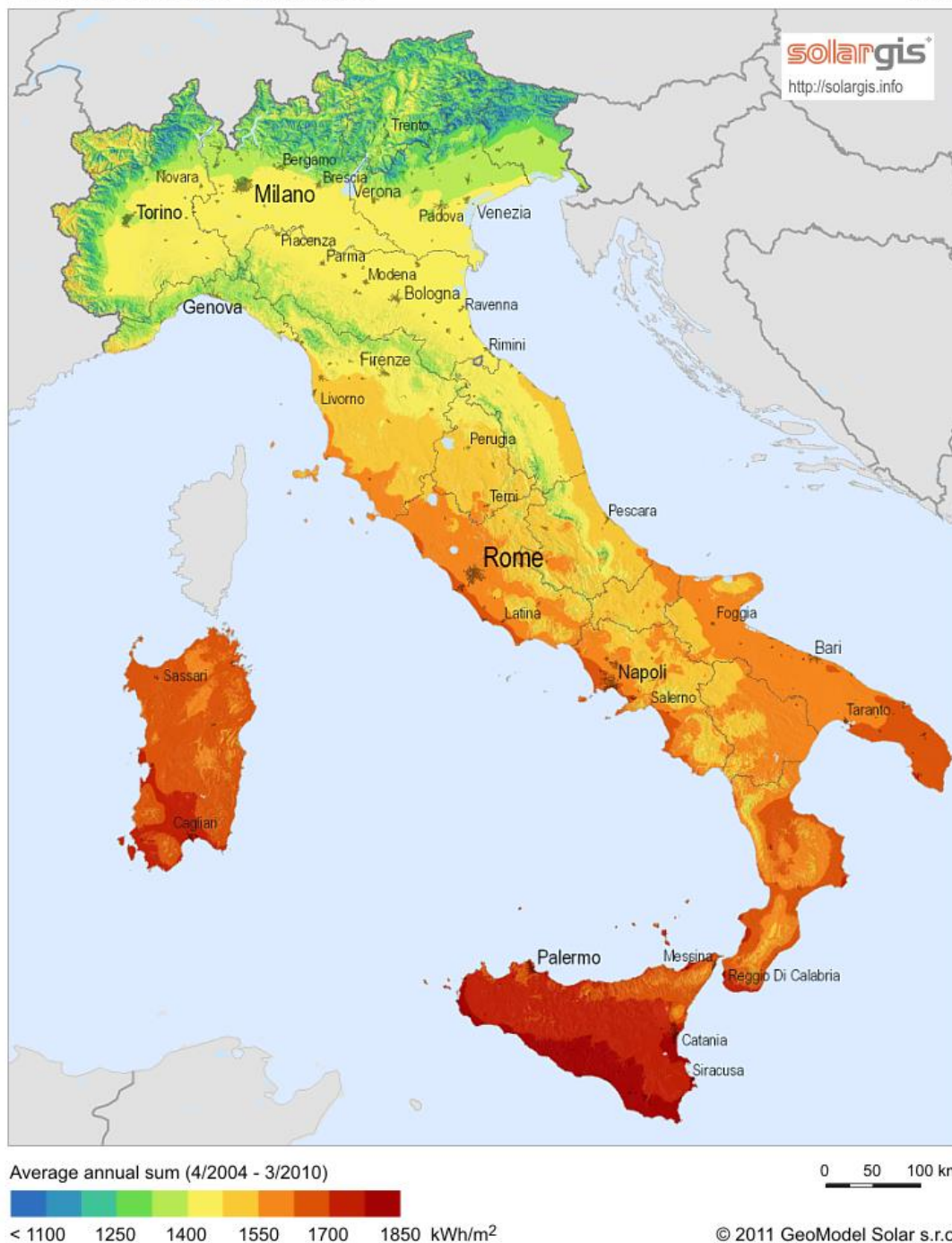
Figura 2.5 – Mappa dell'energia elettrica potenzialmente producibile da processo fotovoltaico nel territorio italiano, espressa come kWh/m 2
