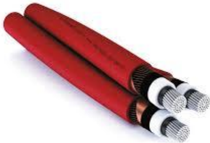
Figura 2.11 - Cavi unipolari del tipo ARG7H1RX tripolare riunito ad elica visibile
