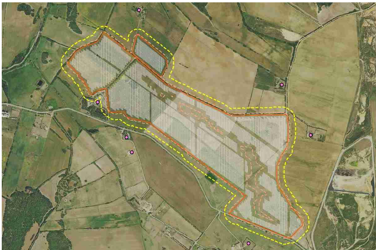
Figura 3.6 – Inquadramento geografico dei ricettori prossimi all'impianto (punti viola) e limiti dei buffer dei 50m e dei 20m dall'area di operatività del macchinario battipalo (rispettivamente in giallo e in rosa))
