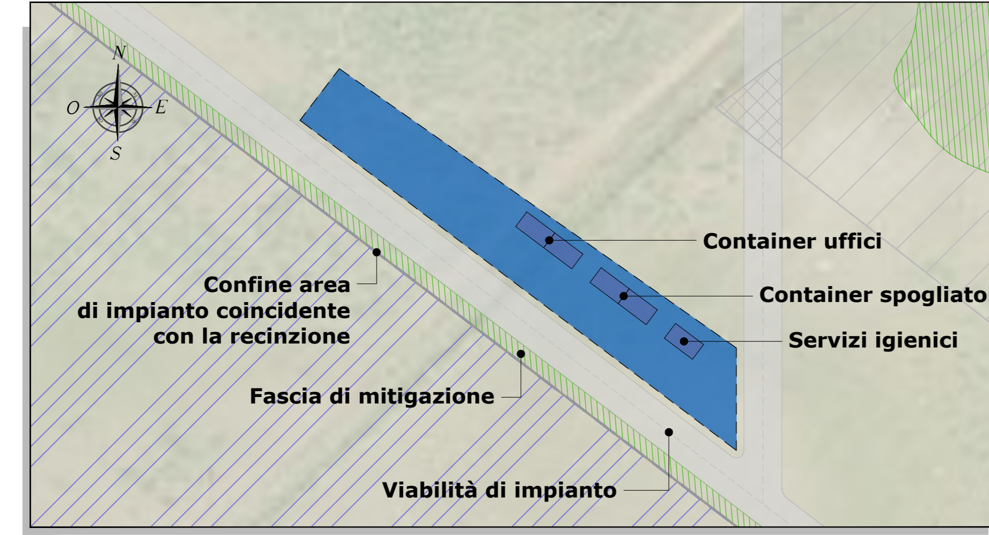
PARTICOLARE 1 AREA DI CANTIERE - SCALA 1:500
