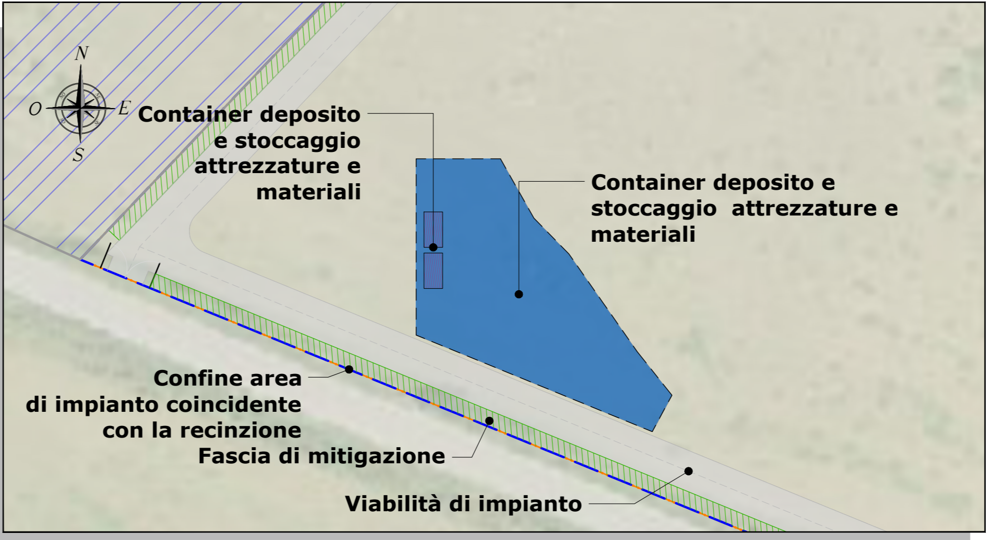
PARTICOLARE 2 AREA DI CANTIERE - SCALA 1:500
