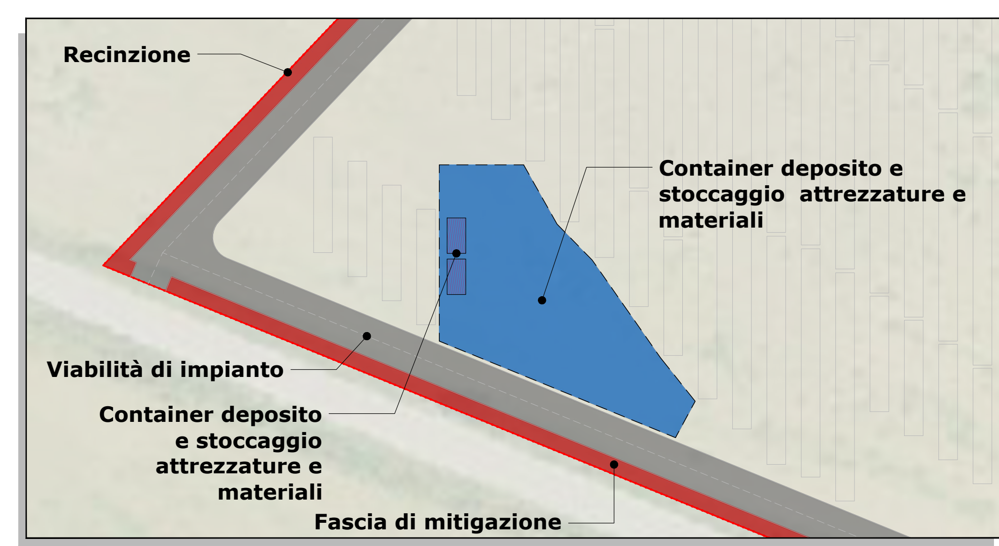
PARTICOLARE 2 AREA DI CANTIERE - SCALA 1:500
