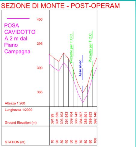
Attraversamento in T.O.C. effettuato in corrispondenza della sezione di monte dell'interferenza N.2. I pozzetti per l'attraversamento in T.O.C. sono posti a 20 m dall'asse alveo in sinistra e destra idraulica. Tale distanza è superiore ai 10 m previsti dal RD 523/1904 ed ai 15 m in sinistra e destra idraulica derivanti dalle modellazioni Idrauliche (vedere planimetrie in EOL-GEO-09 ed EOL-GEO-12)
