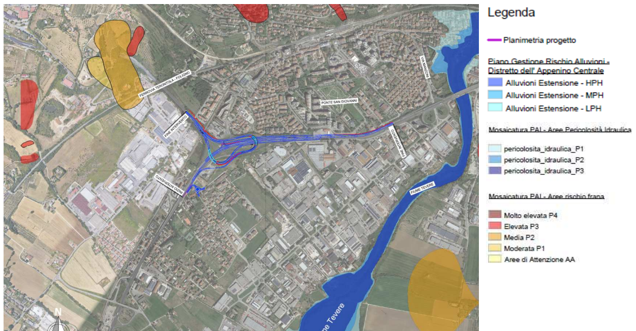
Stralcio Carta PAI - Aree Pericolosità Idraulica, Aree Rischio Frane e Rischio Alluvioni
