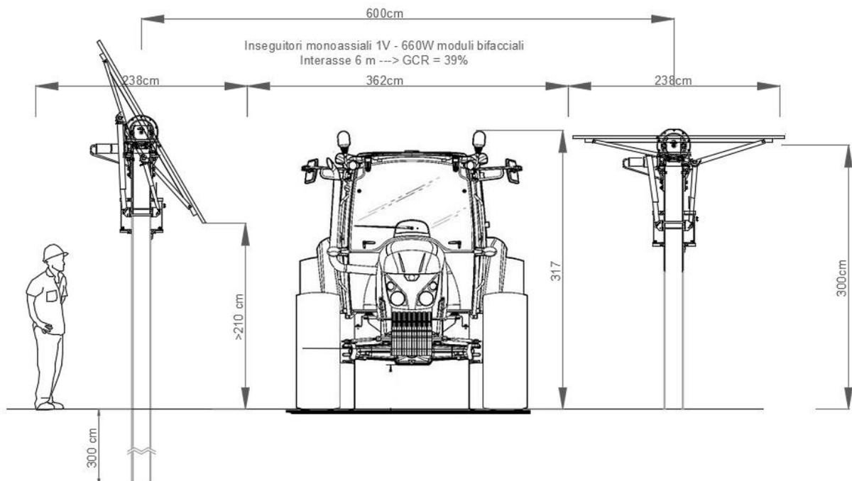
Le misure sopra indicate permettono il passaggio dei mezzi agricoli e le normali attività di coltivazione del terreno, rispettando perciò i requisiti minimi della definizione di agri-voltaico.
