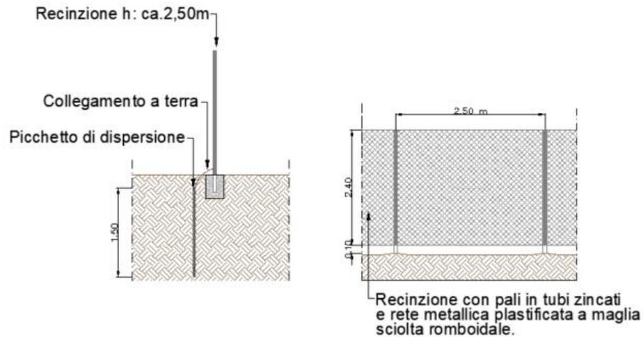
Figura 7 - Rappresentazione della recinzione prevista di altezza pari a 2.5m
