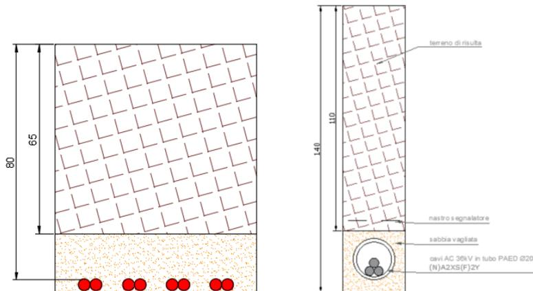
Gli skid, invece, saranno collegati fra loro e alla cabina di raccolta tramite cavi AC a 36kV di adeguata sezione ad una profondità di almeno 100cm e interrati in tubo di DPE. In particolare, si è scelto di prevedere l'utilizzo dei cavi 20.8/36 kV (N)A2XS(F)2Y; con le seguenti sezioni:
