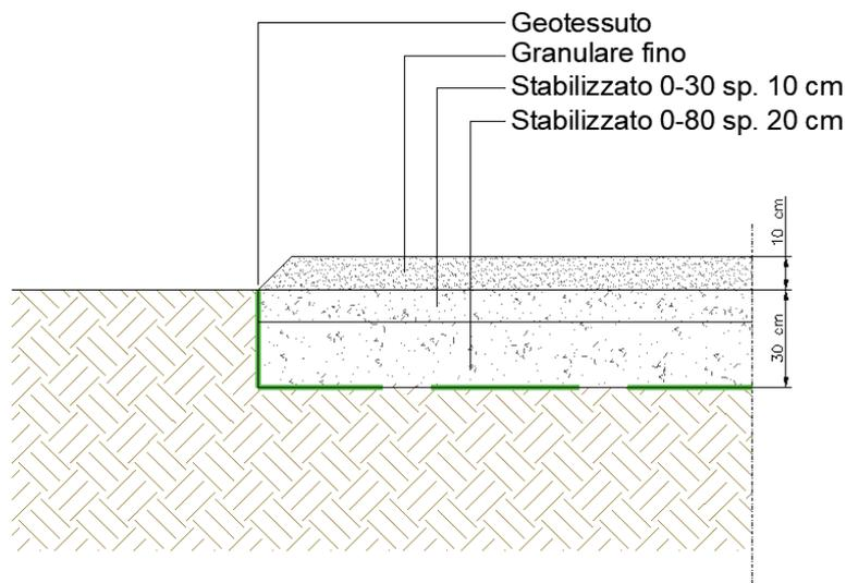
Figura 6 - Sezione tipo viabilità interna all'impianto e piazzali
