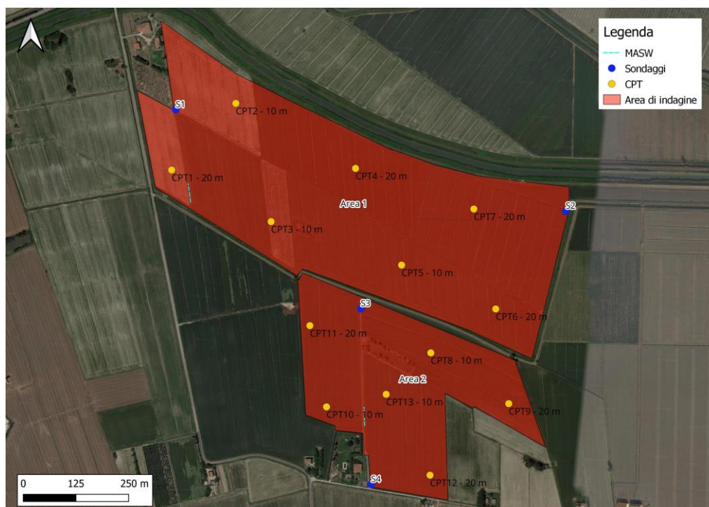
Figura 8 – Estratto foto con ubicazione delle indagini eseguite nell'Area 1 e Area 2 (Google Earth)
