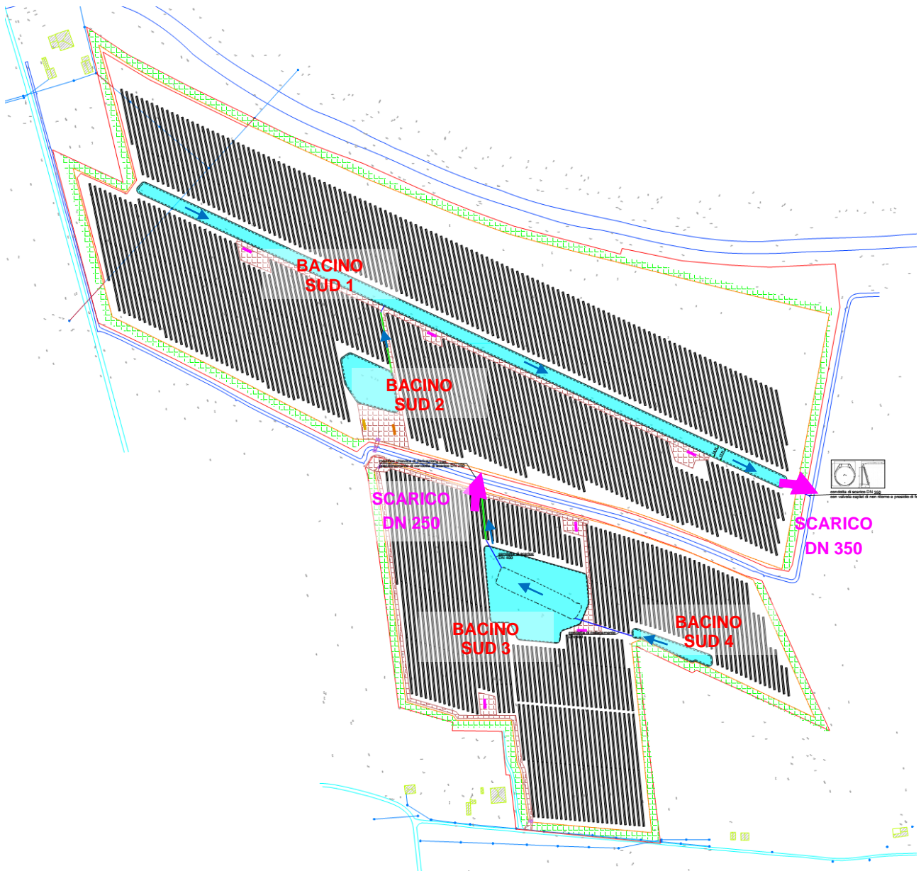
Figura 5.3 - Schema impianto drenaggio acque meteoriche AREA sud
