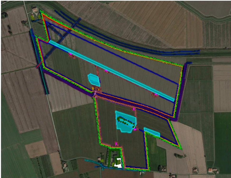
Figura 28 - Idraulica in progetto impianto Sud
