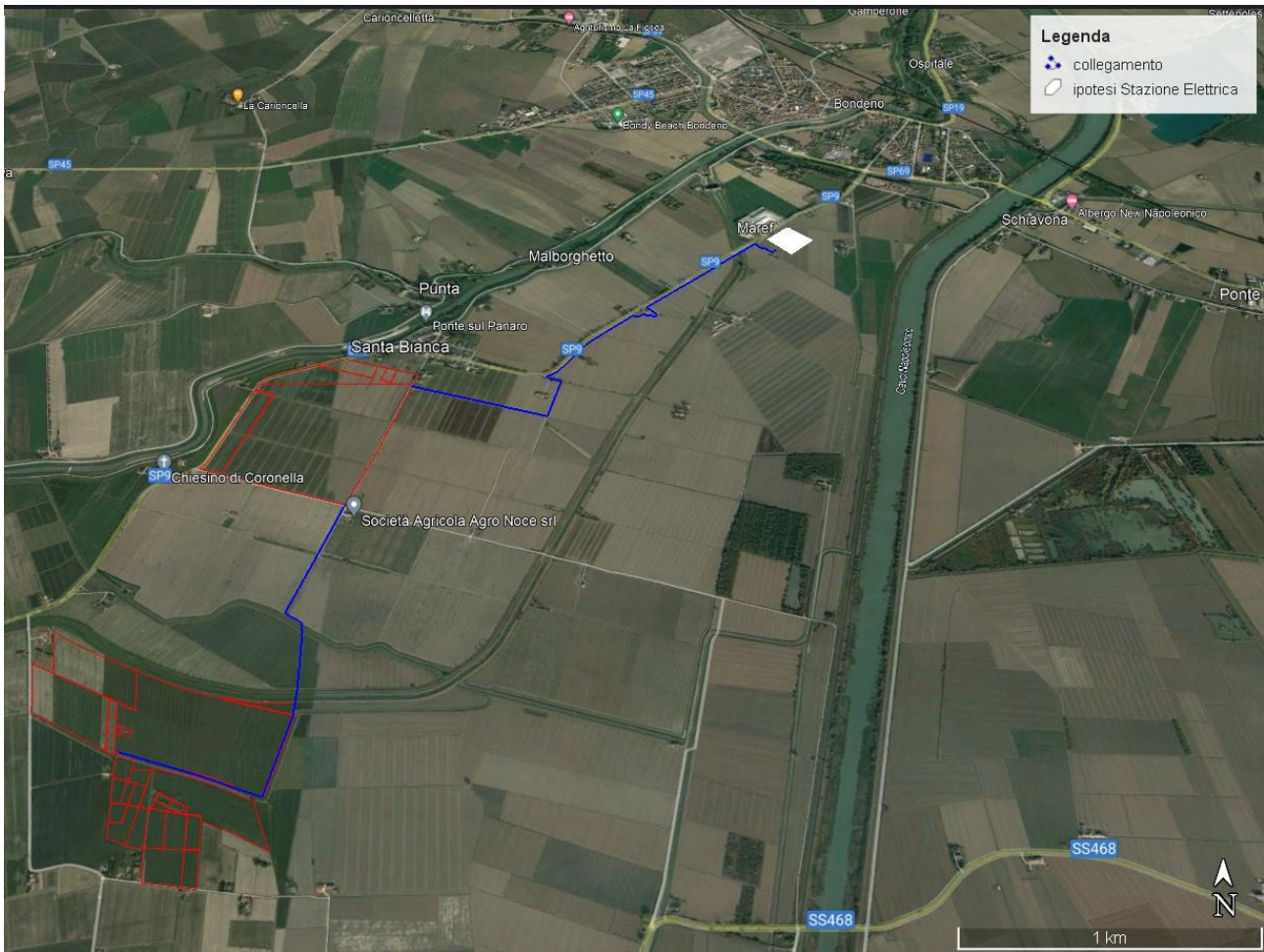
Figura 3 - Area del progetto in esame; in rosso l'impianto agrovoltaico, in blu il cavidotto e in bianco l'ipotesi della stazione Elettrica
