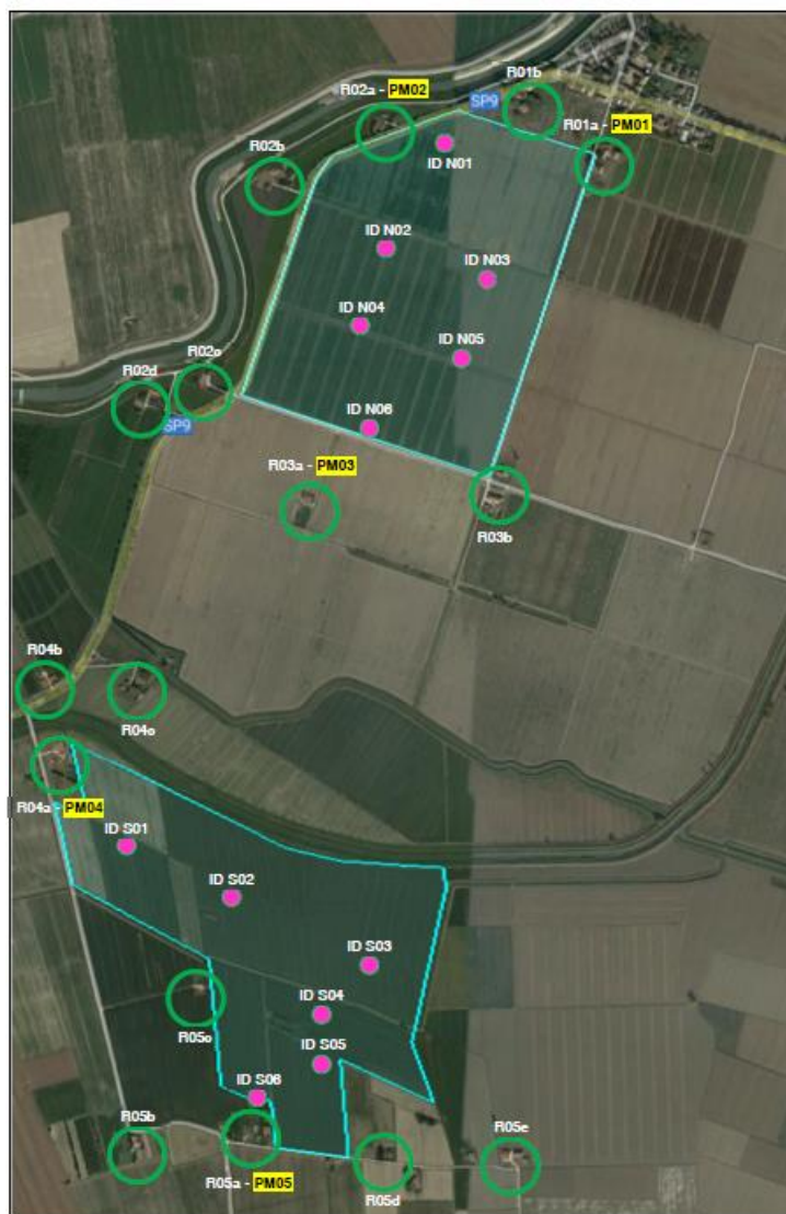
Figura 4 - Foto aerea dell'area di influenza dell'impianto agrivoltaico. Sono indicate le sorgenti di rumore che simulano le stazioni elettriche (cerchietti rosa). Sono inoltre indicati i ricettori presi in esame (cerchietti verdi) tra cui quelli oggetto di monitoraggio ante operam (si nota l'identificativo del punto di misura in colore giallo)
