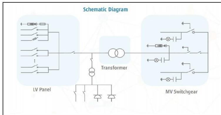
FIGURA 8: SCHEMA DI POSSIBILE COLLEGAMENTO E PROTEZIONE
