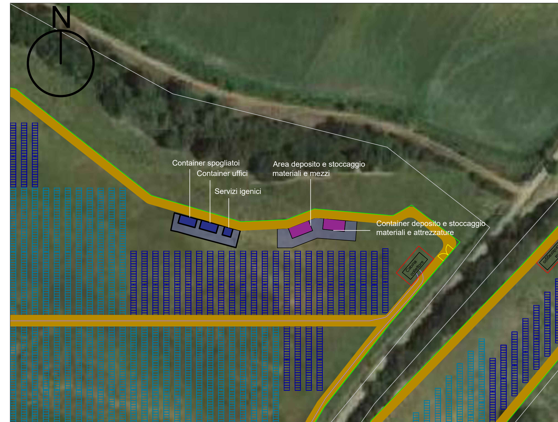
Particolare 1 aree cantiere - Scala 1:1000
