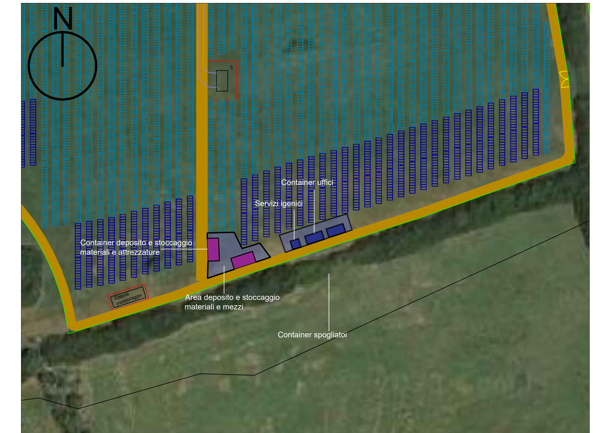
Particolare 4 aree cantiere - Scala 1:1000
