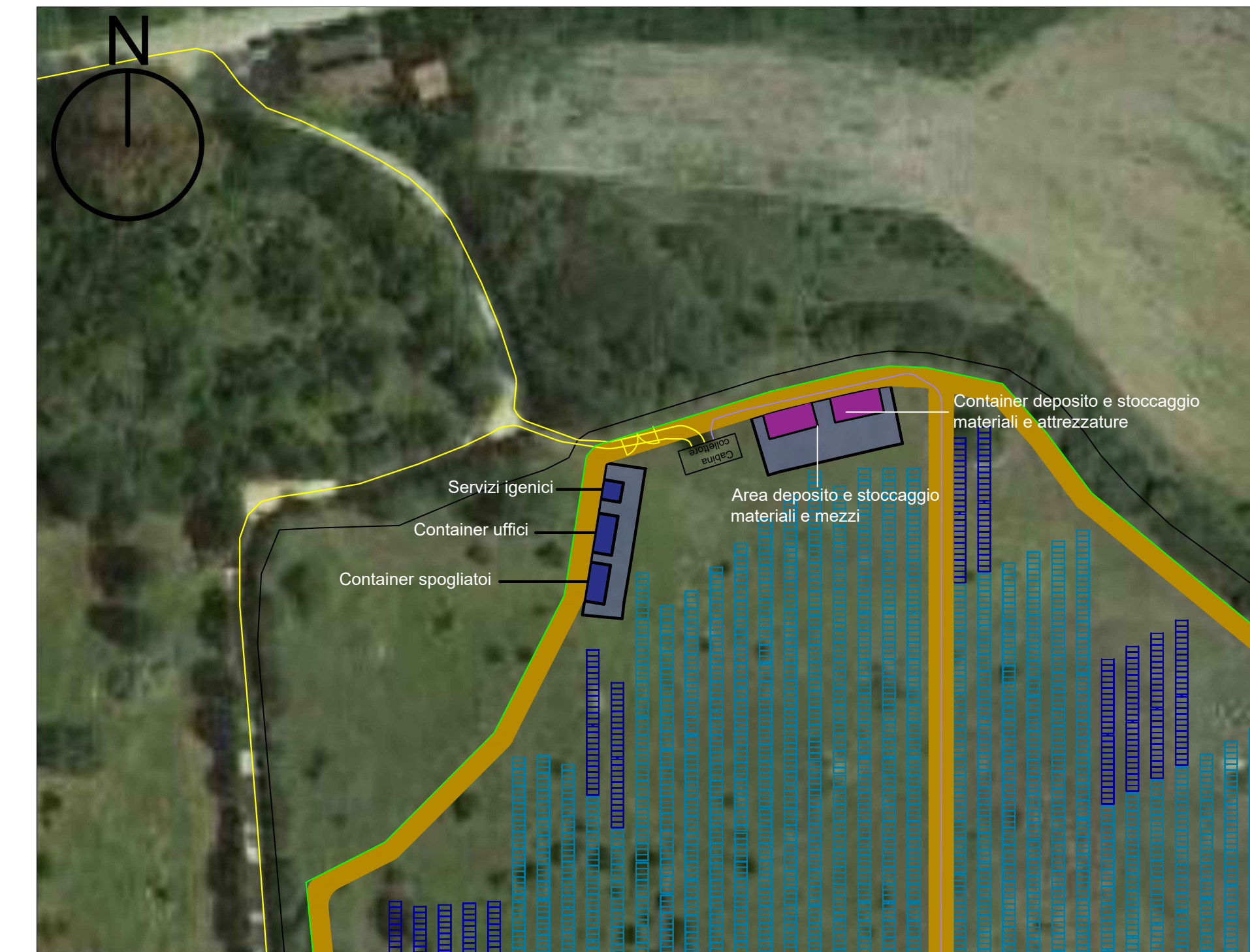
Particolare 3 aree cantiere - Scala 1:1000
