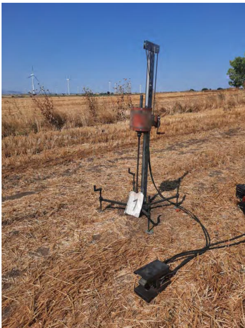
Figura 17 - Realizzazione della prova penetrometrica PP1
