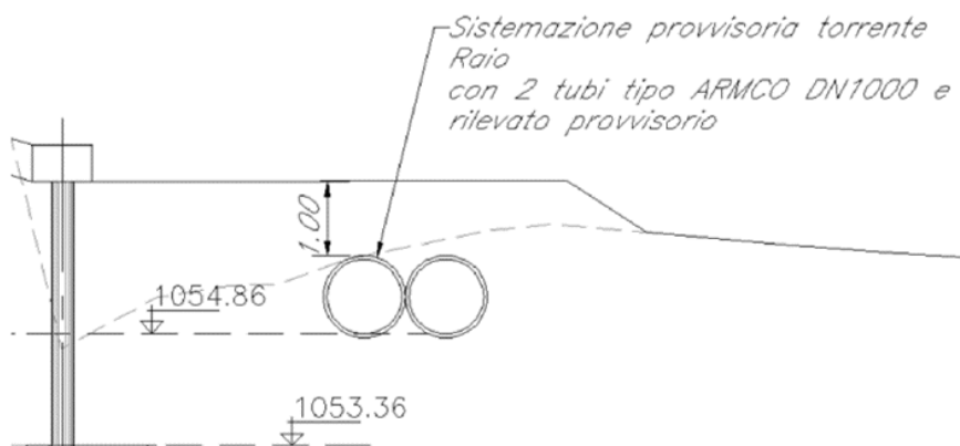
Figura 7 – Sezione della sistemazione provvisoria sulla pila 6
