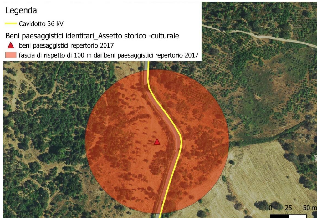
Figura 2.5 Sovrapposizione del tracciato cavidotto interrato 36 kV, ivi impostato su Strada Statale 389 di Buddusò e del Correboi con buffer di 100 metri del "Nuraghe de Orizanne"
