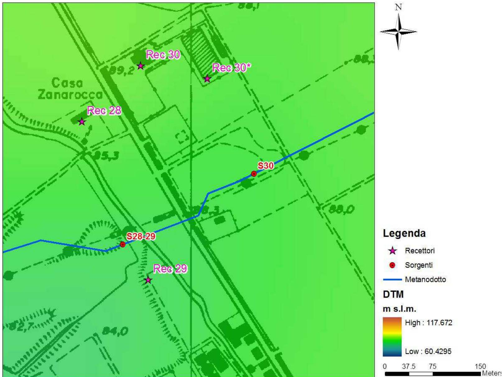
Figura 2 - Localizzazione sorgenti sonore S28-29, S30 e recettori di riferimento (Rec 28, Rec 29, Rec 30, Rec 30\*)
