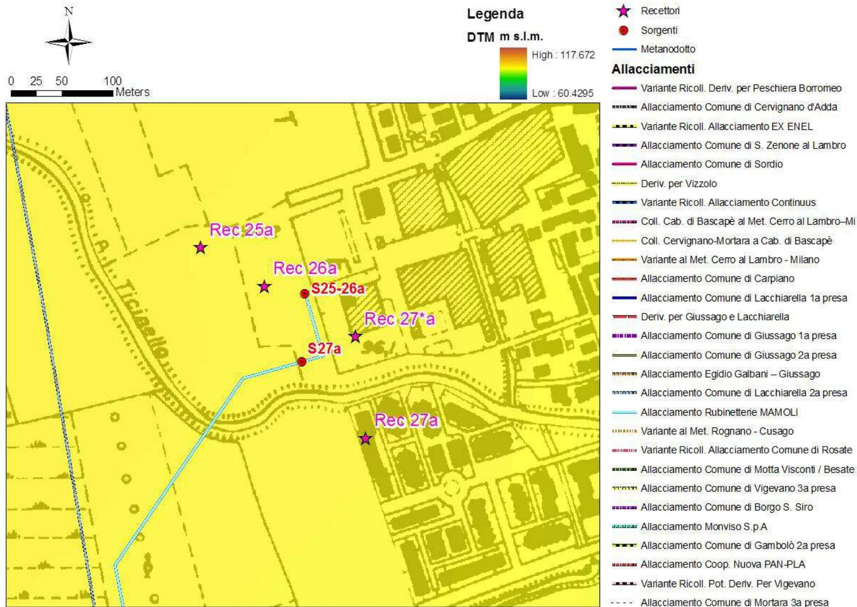
**Figura 4 - Localizzazione sorgenti sonore S25-26a, S27a e recettori di riferimento (Rec 25a, Rec 26a, Rec 27a, Rec 27a\*)**
