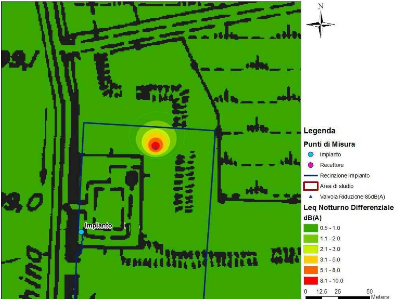
**Fig. 9.8 – Leq Notturmo Differenziale in dBA – Zoom Impianto.**
