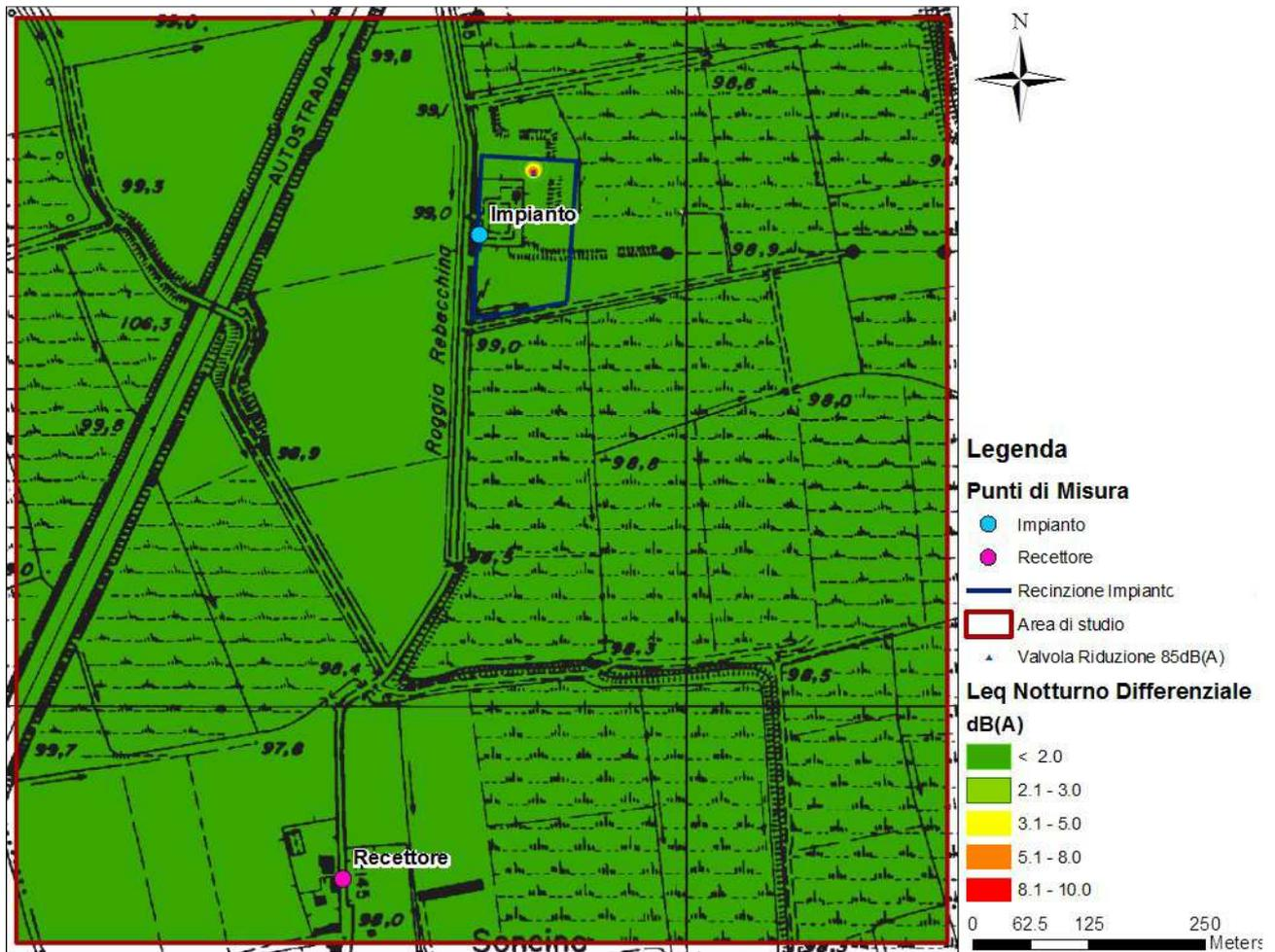
Fig. 9.7 – Leq Notturmo Differenziale in dBA.
