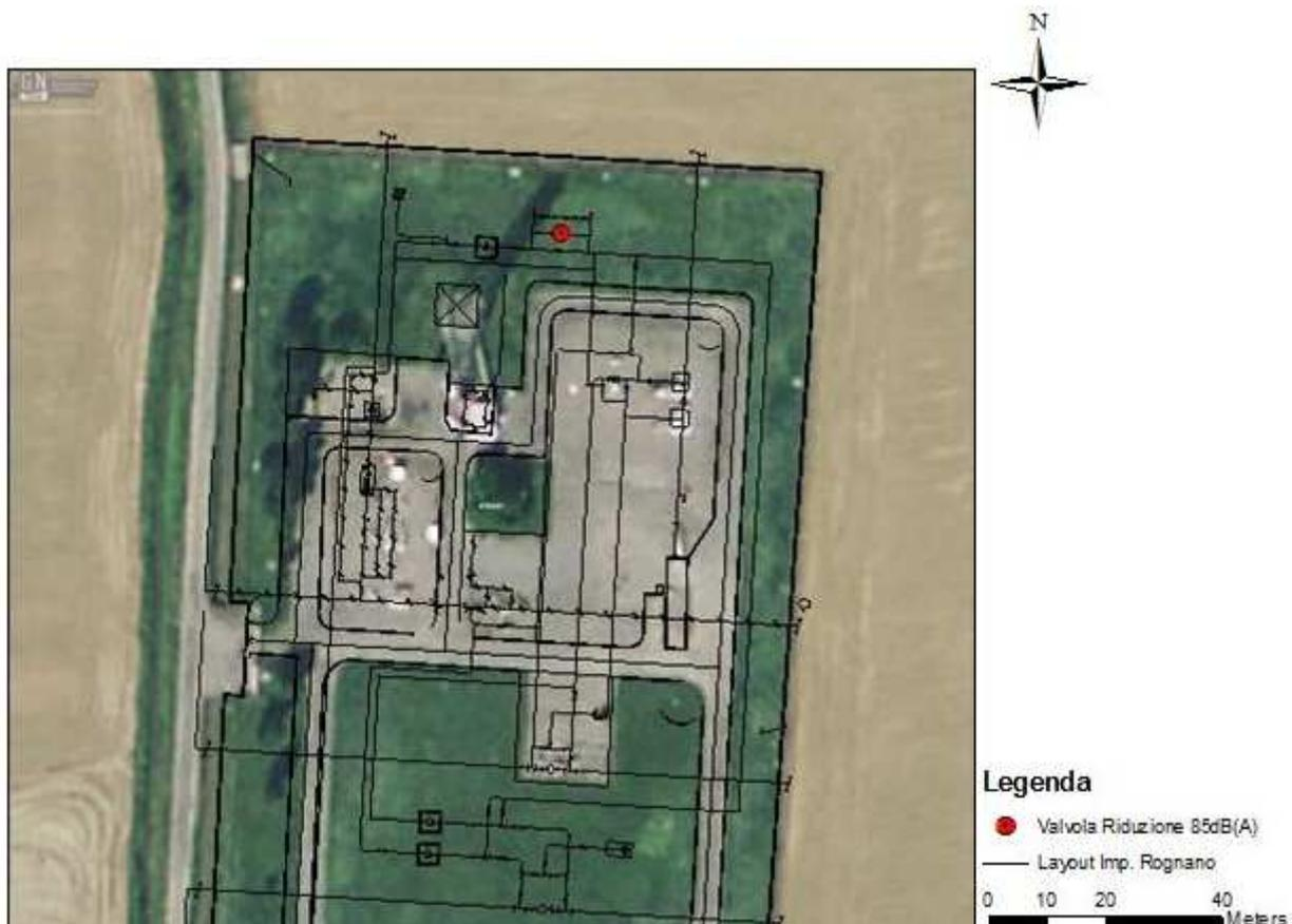
**Fig. 5.1 - Localizzazione sorgenti sonore previste nell'ampliamento dell'impianto.**
