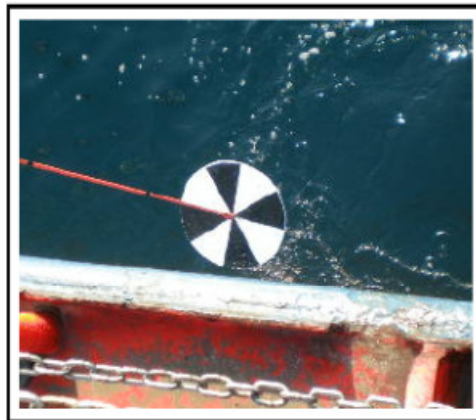
Figura 4-16: disco di secchi (Fonte: "AM 499 Report Ambientale pozzo Atlas1", 2009)
