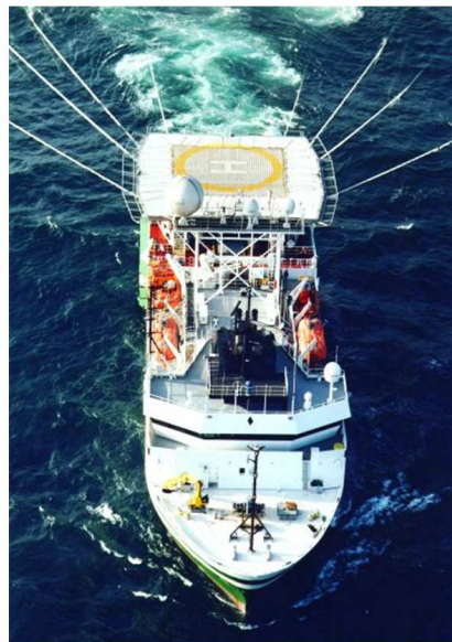
Figura 3-6: esempio di nave per ricerca geofisica impegnata in un rilievo sismico 3D con una configurazione a otto cavi (Fonte: eni s.p.a. divisione e&p)
