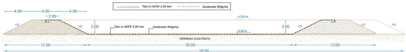
Figura 6: Sezione tipo vasca di colmata per deposito sedimenti dragati;
