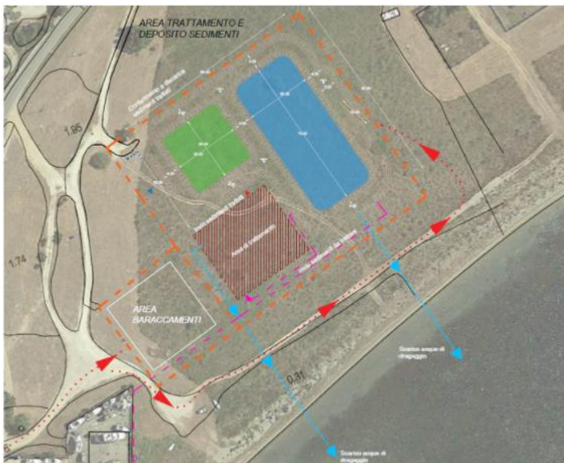
Figura 5: Dettaglio dell'area di cantiere a terra destinata a vasche di colmata e impianto di trattamento delle materie provenienti dagli escavi prevista nelle aree esterne adiacenti al porto.
