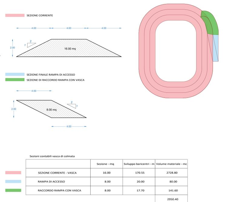
Sezione trasversale A-A vasca di colmata\_scala 1:100
