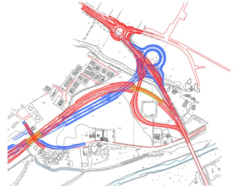
Riquadro 12 - L'allaccio sud dell'infrastruttura è stato ridisegnato con l'eliminazione della rotonda centrale prima in progetto, la sua sostituzione con uno snodo differente e la realizzazione di una galleria.
