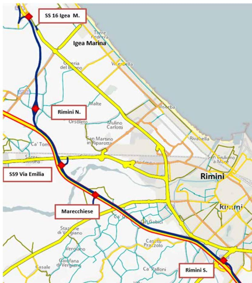
Figura 3-3 – Svincoli del progetto della Variante alla SS16 a nord di Rimini
