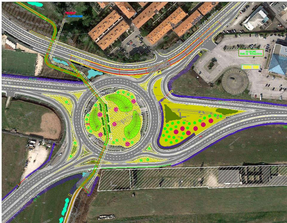
Figura 2-4 – Confronto progetto. Rotatoria di regolazione flussi veicolari presso lo svincolo Rimini Sud
