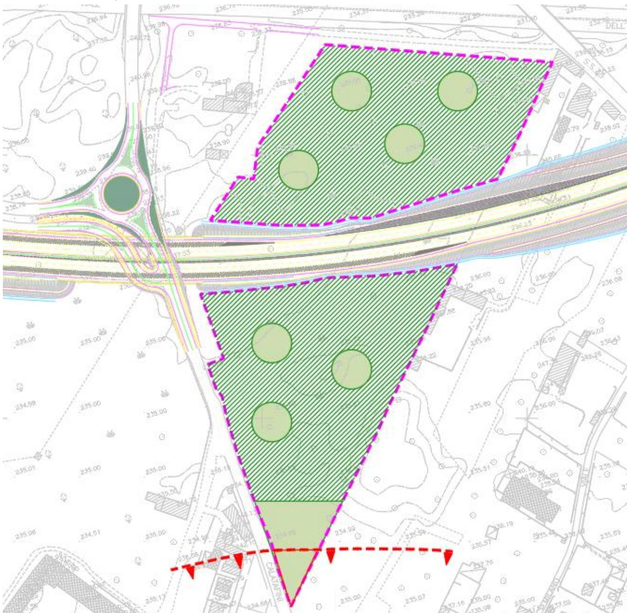
Area di rimboschimento con radure erbose: in rosso il perimetro della zona infestata da Tarlo asiatico, in verde pieno le radure erbose in progetto, mediante retinatura verde scura sono indicate le superfici di rimboschimento.
