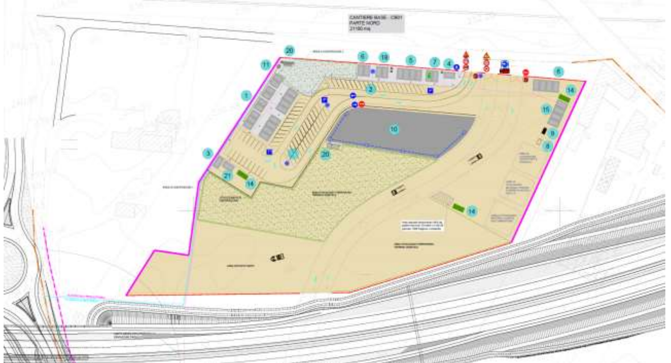
Figura 3 - Layout di cantiere base CB01 parte nord
