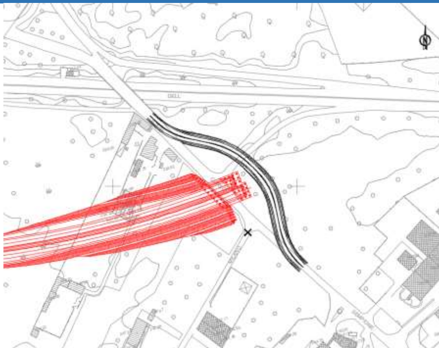
Figura 21 - Planimetria deviazione provvisoria su C.so Sempione (in nero) e aree in lavorazione (in rosso)
