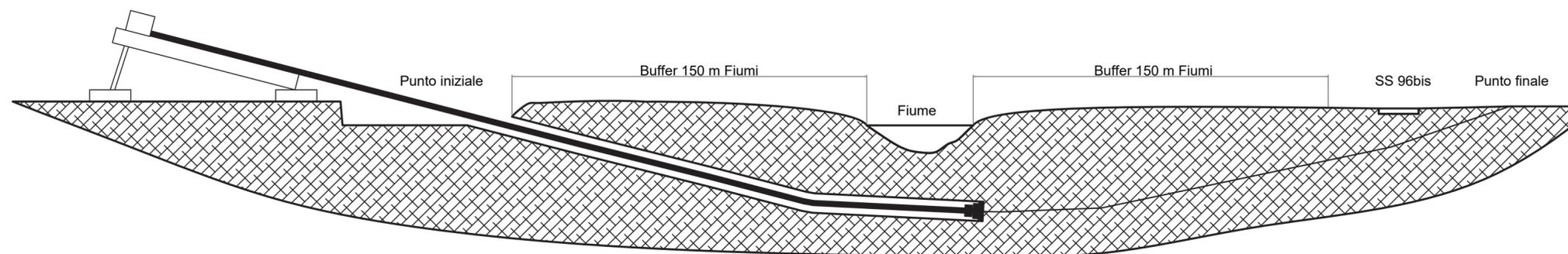
**Interferenza cavidotto / Corso d'acqua
