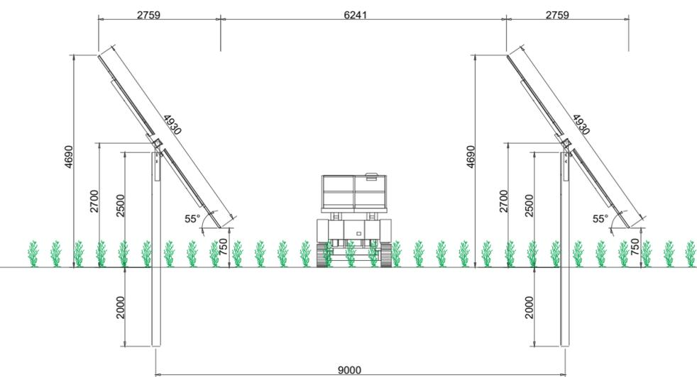
Tracker - Configurazione massima rotazione - Sezione laterale
