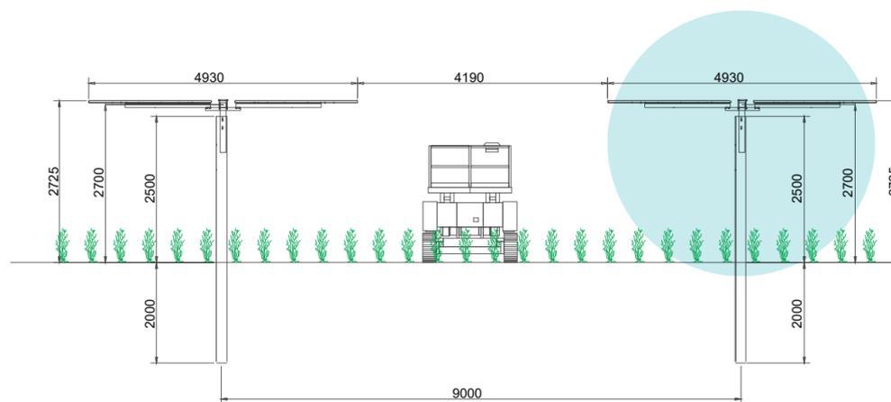
Tracker - Configurazione orizzontale - Sezione laterale
