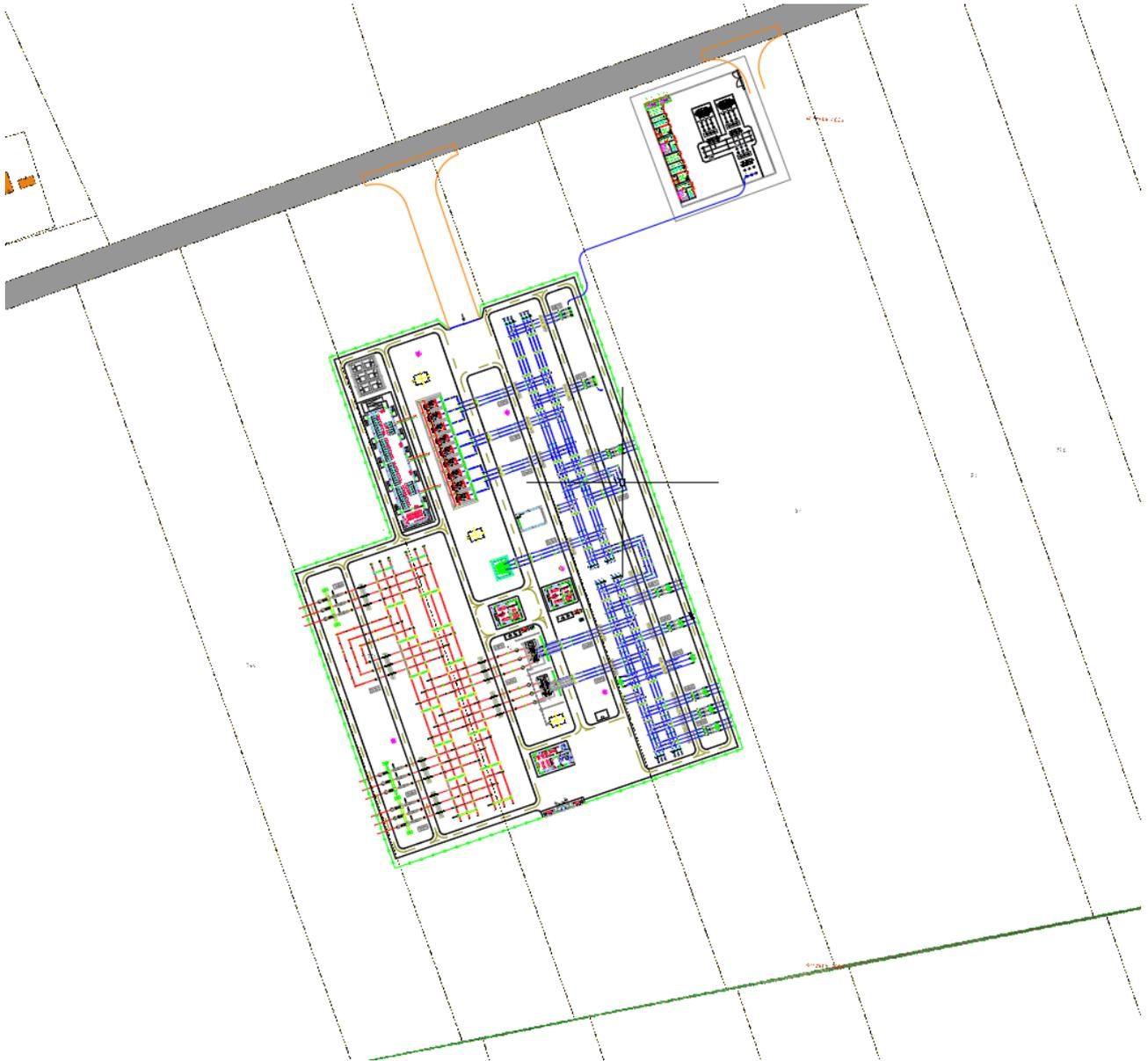
La stazione elettrica utente sarà dotata di un trasformatore di potenza con relativi edifici tecnici adibiti al controllo e alla misura dell'energia prodotta ed immessa in rete.
