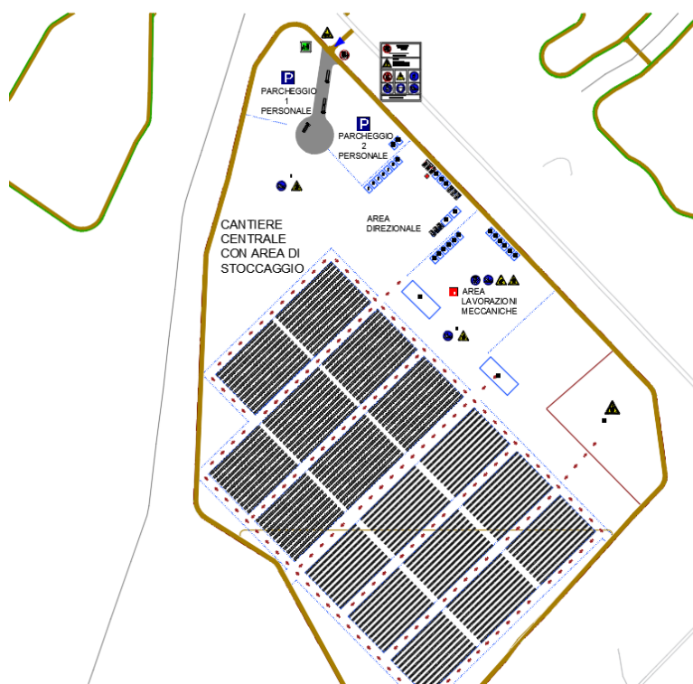
Fig.2 – Ricezione, stoccaggio e movimentazione materiali, dettaglio apprestamenti piastra 11 (cantiere 1)
