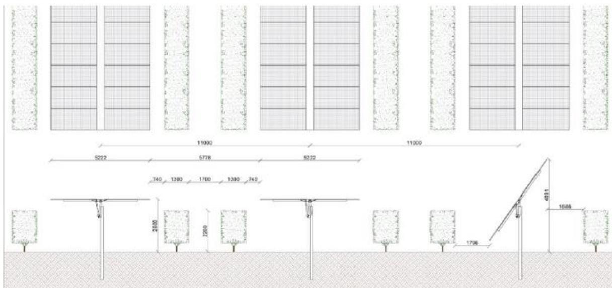
**Figura 4. Dettaglio layout impianto agri-voltaico**
