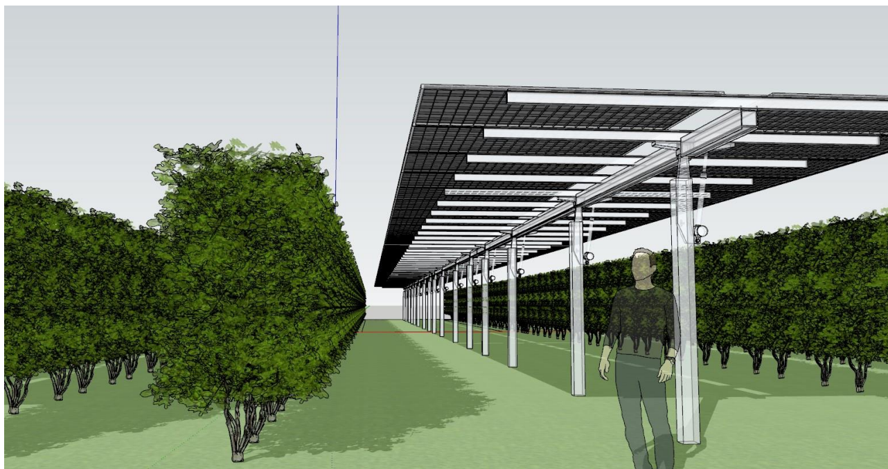
Figura 9 - Immagine impianto, altezza media 2,8 mt
