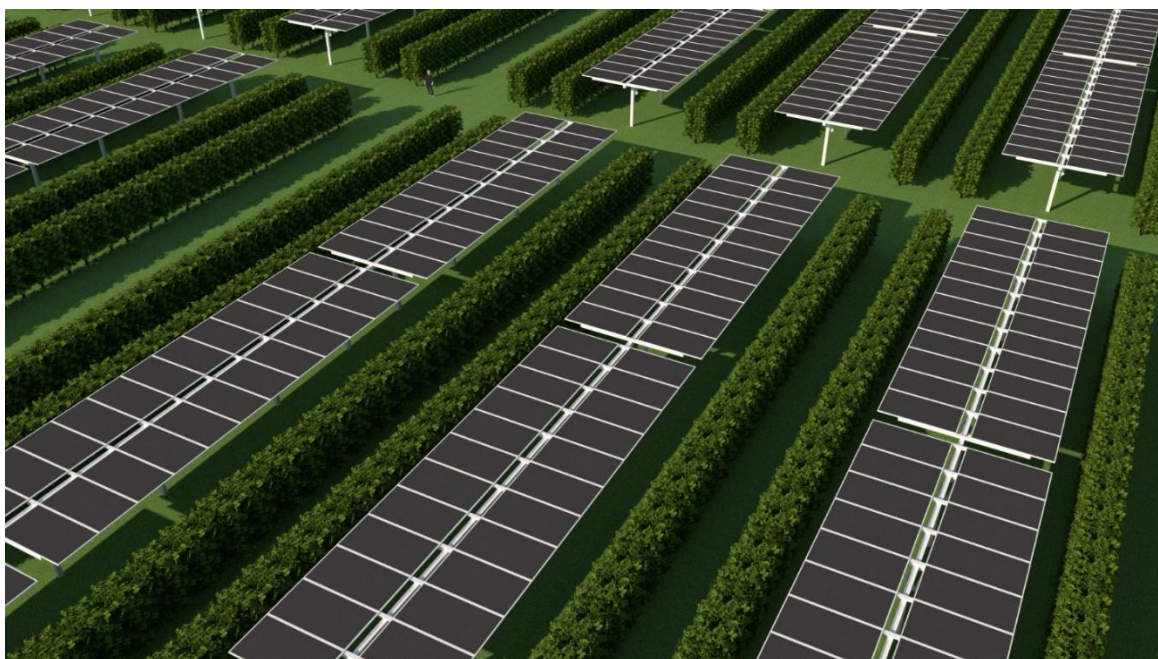
Figura 79 - Particolare del modello, siepi ulivicole e tracker in posizione orizzontale
